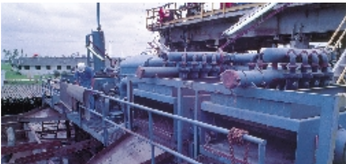
Desarenadores y desenturbadores utilizan los acoplamientos estándar y de desconexión rápida Snap-Joint® para facilitar el servicio.
